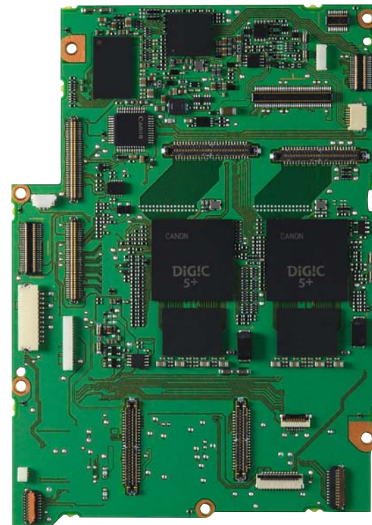
Das Gehirn der EOS-1D X sind zwei neue Digic 5+ Prozessoren, die etwa dreimal so schnell arbeiten wie der Digic 5 Prozessor
