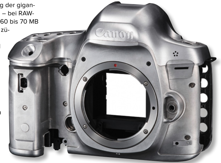
Das Chassis aus Magnesiumlegierung wurde verstärkt, um so mehr Stabilität zu bieten
