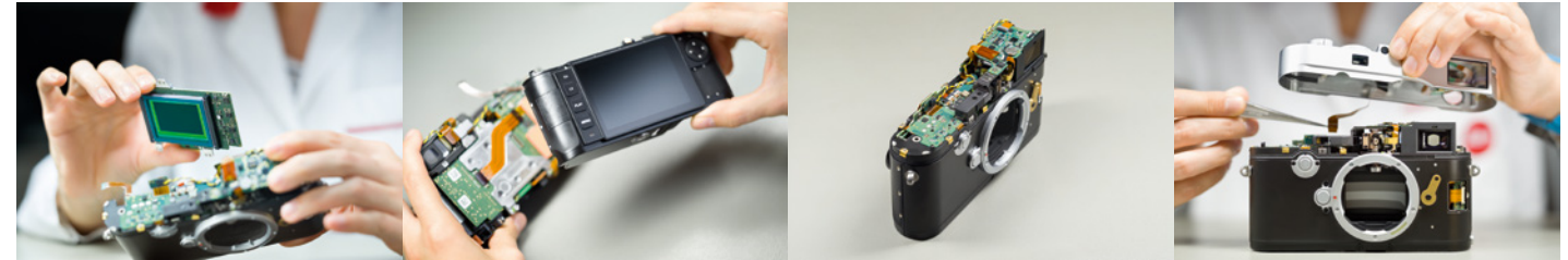
Montage des Sensors in Verbindung mit dem Imageboard
