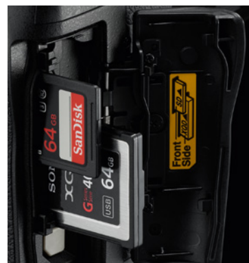
Der Doppelkartenschacht der D850 bietet Platz für je eine XQD- und SD-Karte
