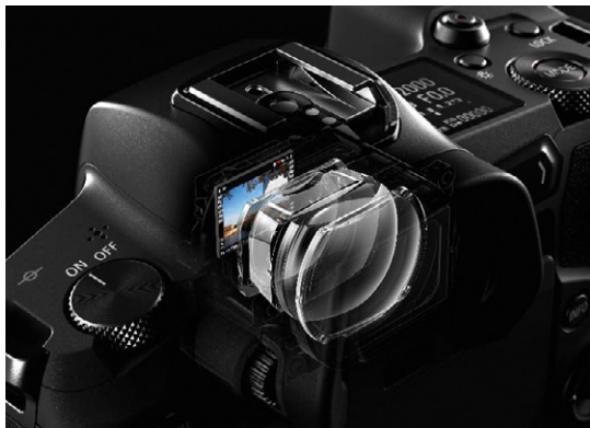
Der Elektronische Sucher (EVF) bietet 3,69 Millionen Bildpunkte und 100 %-Bildfeldabdeckung
