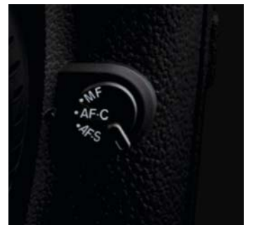
Die Fokusmodi werden auf der Kameravorderseite eingestellt
