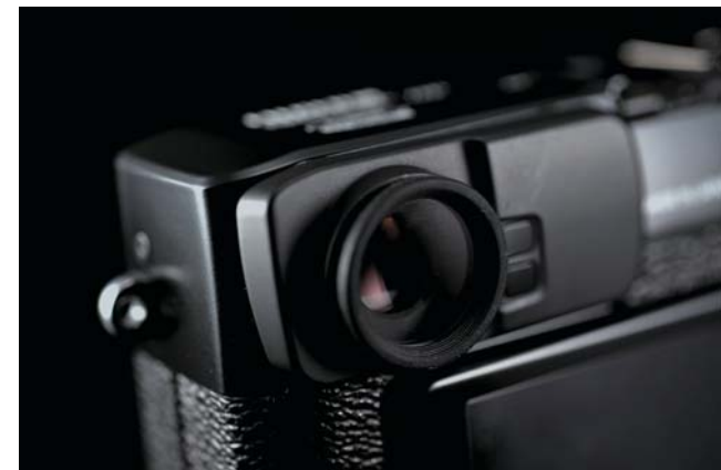
Der Multi-Hybrid-Optische-Sucher ermöglicht, die Informationen des elektronischen Suchers in das optische Sucherbild einzublenden
