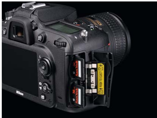
Das obere und hintere Gehäusestück der D7100 besteht aus einer stabilen Magnesiumlegierung
