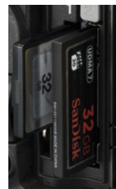
Für Speicherme- dien stehen Kar- tenfächer für High-Speed-CF-Karten (UDMA 7) bezie- hungsweise High-Speed-XQD-Karten zur Verfügung
