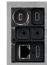
Die Kamera verfügt unter anderem über einen superschnellen Gigabit-100/1000TX-Ethernet-Anschluss
