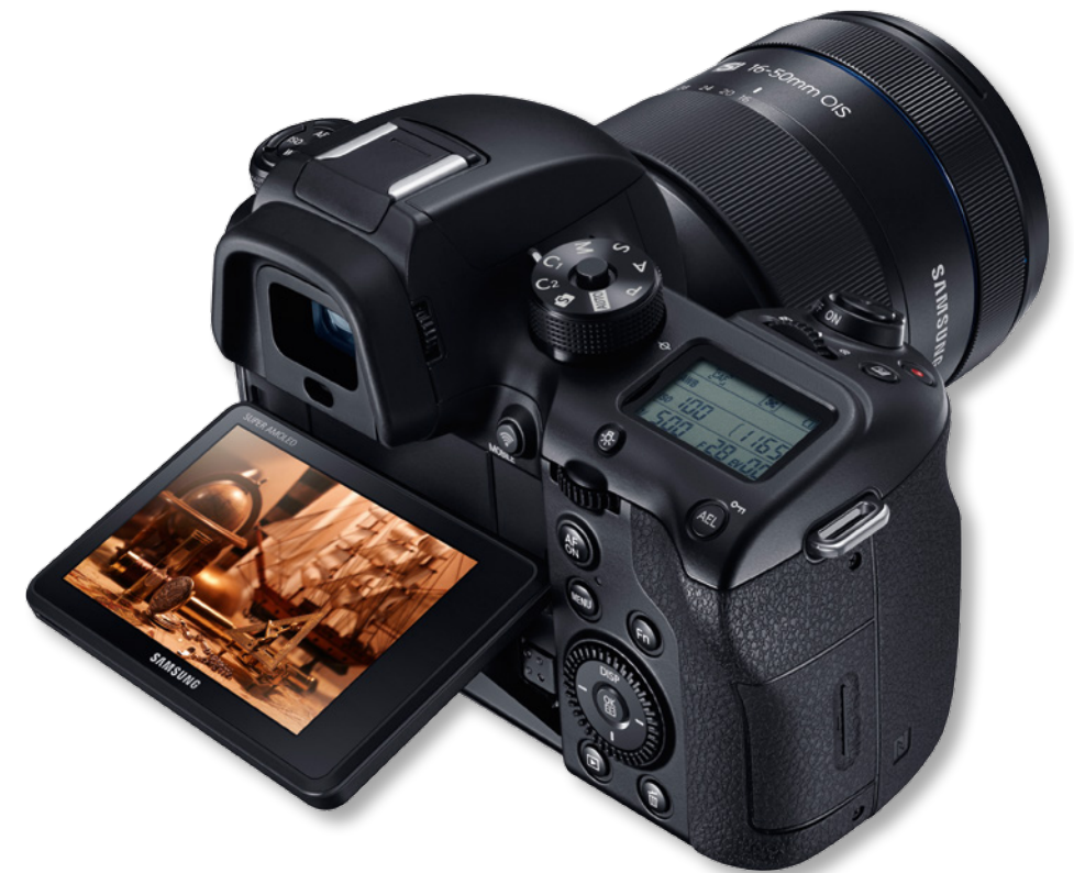
Praktisch: Um die Bedienung besser an die Drehgewohnheiten und persönlichen Vorlieben anzupassen, können Filmemacher die Funktionen einiger Tasten neu belegen
