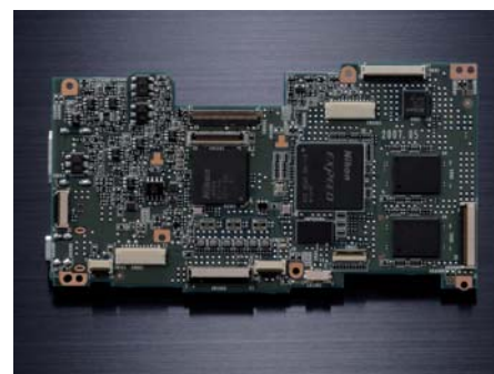
Der Expeed-Bildprozessor arbeitet extrem schnell und ermöglicht eine Vielzahl an Bildoptimierungs-Optionen vor und nach der Aufnahme
