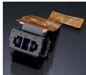
Das Motiv-Erkennungssystem der Nikon D3 kombiniert die Daten aller TTL-Sensoren der Kamera und nutzt unter anderem den 1.005-Pixel-RGB-Sensor zur Unterstützung der Autofokus-Steuerung
