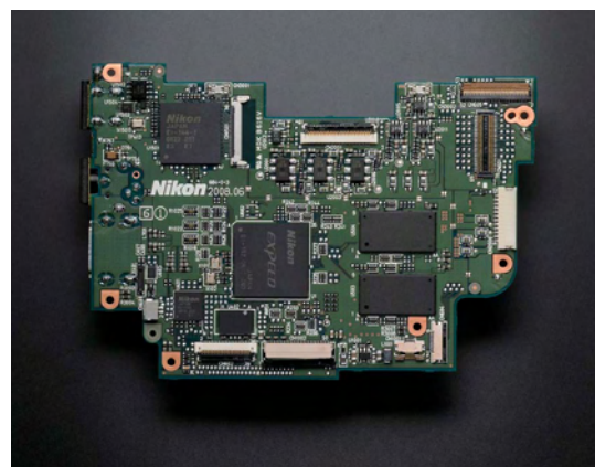
Das EXPEED Bildverarbeitungssystem der D3X ermöglicht eine hohe Bildrate und liefert NEF-(RAW)-Dateien mit einer Farbtiefe von 14-Bit
