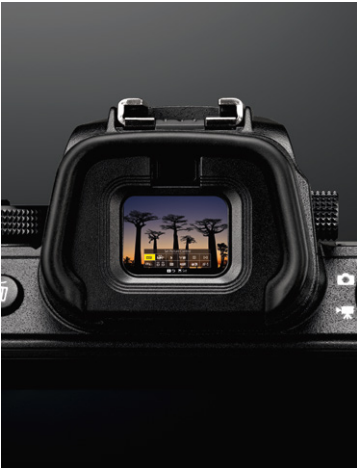
Beide Kameras sind mit einem OLED-Display mit 3,69 Millionen Bildpunkten ausgestattet. Der Sucher bietet eine Bildfeldabdeckung von rund 100 Prozent und einen Vergrößerungsfaktor von 0,8
