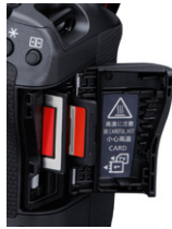
Wahlweise stehen CFexpress- und SD-Speicherkartenfächer zur Auswahl
